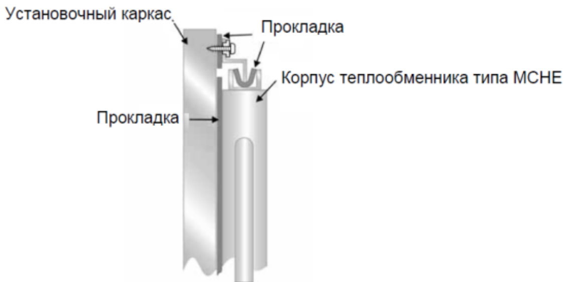
Монтаж теплообменников микроканальных типа МСНЕ.
